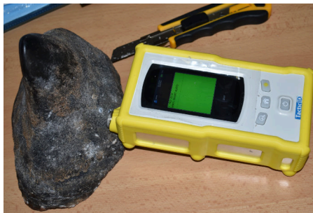
Měření falešné rohoviny pomocí Ramanova spektrometru (foto Dominika Formanová)
