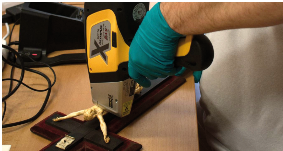
Měření slonoviny pomocí RTG fluorescenčního spektrometru Delta (foto Pavla Říhová)
