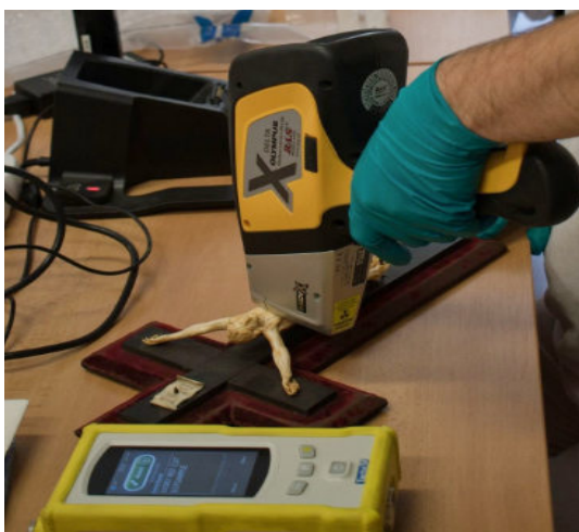
Použití ED-XRF Delta spektrometru pro měření slonoviny (foto Pavla Říhová).
