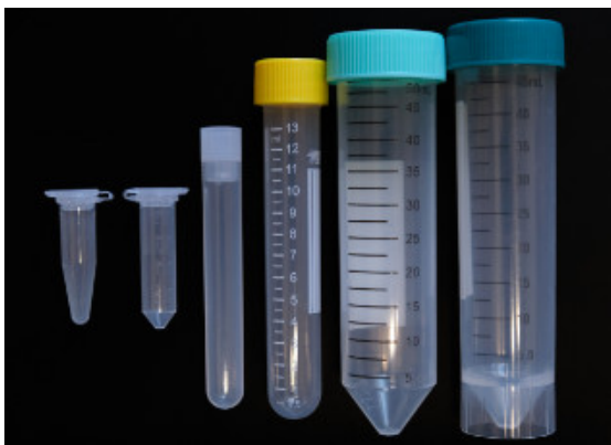
Různé typy odběrových zkumavek vyrobené z plastu odolného vůči chladu, lze je bezpečně skladovat i v podmínkách ultra chladu (-80°C) (foto Zdeněk Novák).
