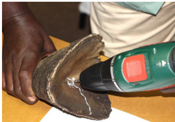
Odběr vzorku nosorožčího rohu (foto Pavla Říhová).
