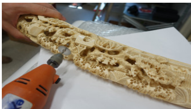
Někdy je možné vzorek odebrat i odříznutím malé části předmětu pomocí minibrusky (foto Zdeněk Novák).
