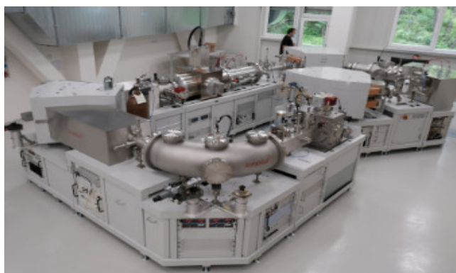
Urychlovačový hmotnostní spektrometr AMS MILEA (foto Ústav jaderné fyziky, AV ČR).
