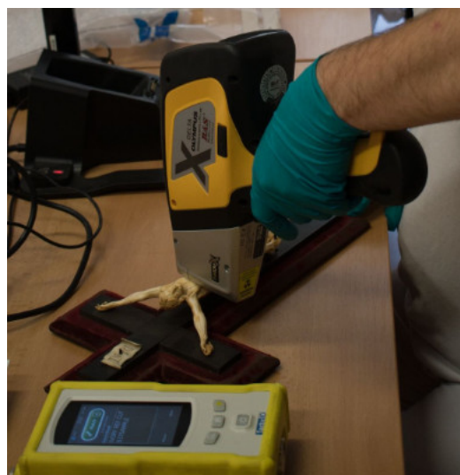
Použití ED-XRF Delta spektrometru pro měření slonoviny (foto Pavla Říhová)
