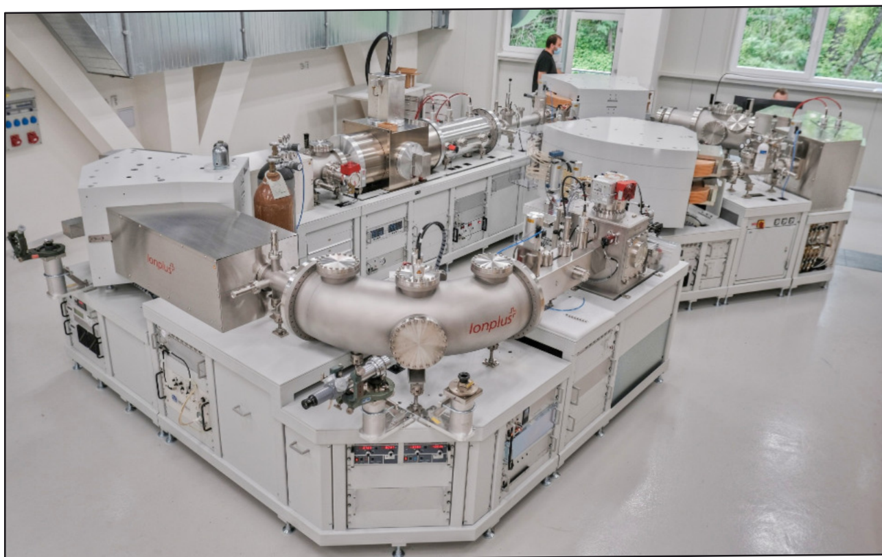
Urychlovačový hmotnostní spektrometr AMS MILEA (foto archiv Ústavu jaderné fyziky, AV ČR)
